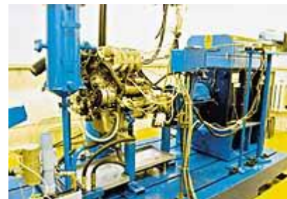
Стенд AVL для исследования и доводки двигателей ...
