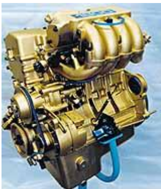
Двигатель УЗАМ рабочим объемом 1,8 л, оснащенный СРВТ.
